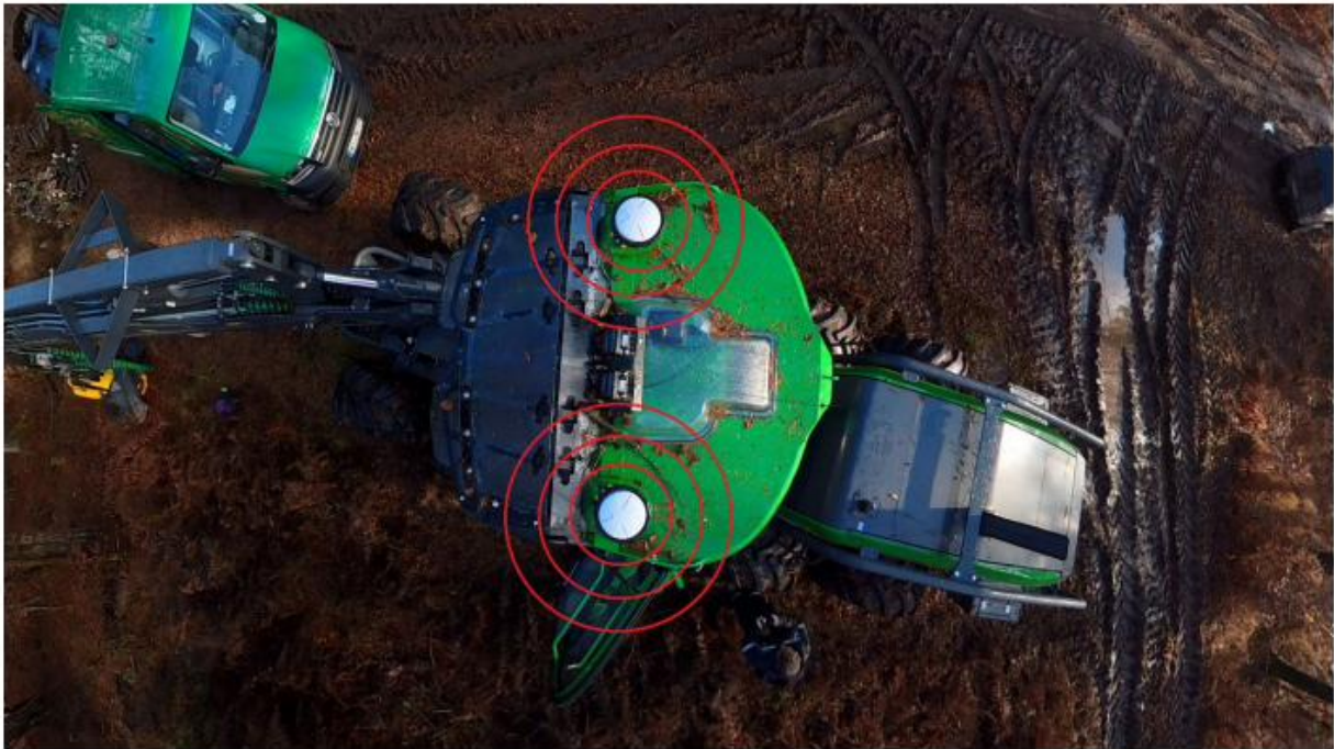
Abb. 1: Zwei RTK-Module (rote Umrandung) auf einem John Deere Harvester (Bild: René Tiethboehl)
